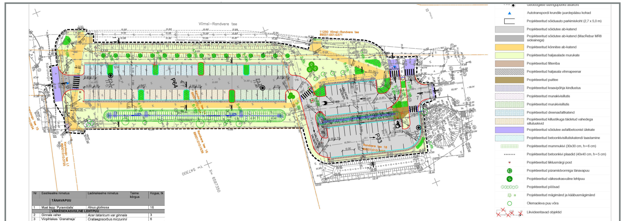
S17 I načrt pilotnega parkirišča s prepustnimi in travnimi tlaki v Haabneemeju, občina Viimsi
